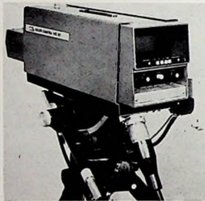
Afb. 2. KTV-camera type IVC-151. Deze camera heeft alle hulp- en stuurcircuits „aan boord" en behoeft alleen qua netvoeding en uitgang te worden aangesloten, hetgeen hem met een definitie van 400 lijnen zeer geschikt maakt voor bedrijf in gesloten circuits.
