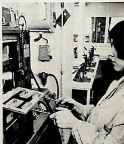
Strips met 128 E-line transistoren van Ferranti worden in stukjes van 16 geknipt en in een frame geplaatst om te worden ingekapseld.
