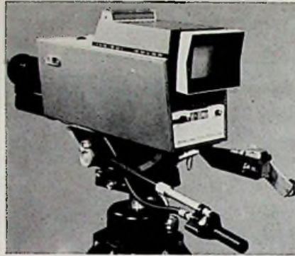
Afb. 1. Kleuren-TV-camera type IVC-501 met plumbicon-opneembuizen in het groene en blauwe kanaal en een siliciumdiode-opneembuis in het rode kanaal.
