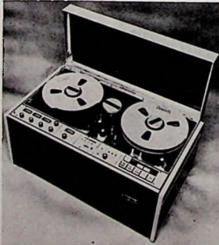
Afb. 3. Magnetoscoop type IVC-900 in kofertuitvoering, werkend volgens het spiraalafstapprincipe volgens professionele eisen. Maximale speelduur 3,5 uur.
